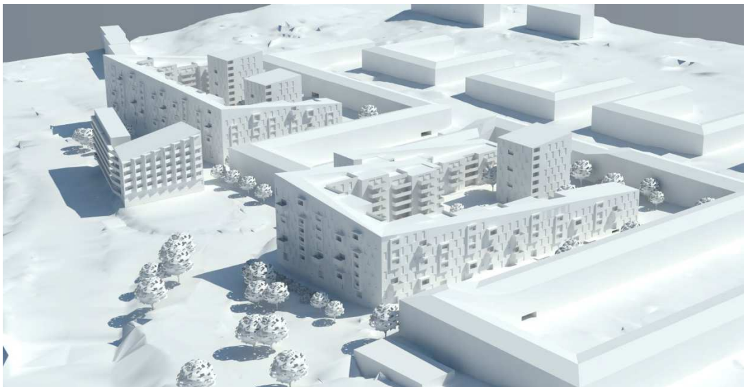
Perspektivbild från nordväst. De tillkommande kvarteren bryts upp i mötet med Pennygången för att möjliggöra utblickar från befintliga bostäder och släppa in solljus från söder. I likhet med det befintliga Pennygången sluts kvarteren mot Högsboleden vilket skärmar från bullerstörningar. Illustration White arkitekter.
